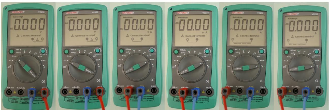
2. Schließe das Messgerät mit den richtigen **Buchsen** an. Das Gerät zeigt immer an, welche Buchsen du bei der gewählten Einstellungen verwenden musst: Unter der Anzeige **Connected terminal** findest du zwei Kreise, die mit zwei der Buchsen unten korrespondieren in die du die Stecker entsprechend einsteckst (siehe Abbildungen oben).
